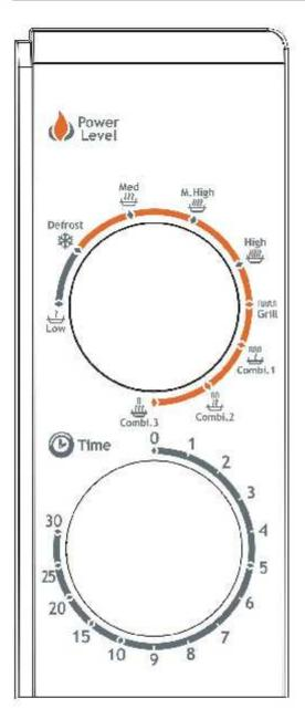
EL panel de control consta de dos reguladores: el primero permite ajustar la potencia mientras que el segundo permite ajustar el tiempo.
